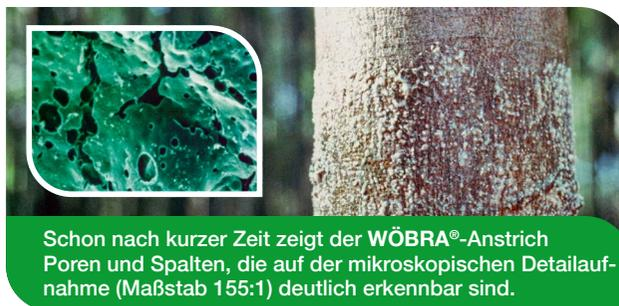
Schon nach kurzer Zeit zeigt der WÖBRA®-Anstrich Poren und Spalten, die auf der mikroskopischen Detailaufnahme (Maßstab 155:1) deutlich erkennbar sind.
